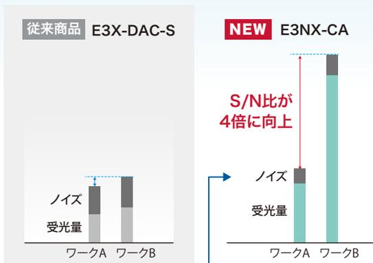
ハイパワーとノイズ低減により、投光側で1/100倍、受光側で1/3倍にまで光量調整範囲が拡大。従来商品比4倍のハイダイナミックレンジ(広い受光量調整範囲)を実現し、反射率99%の光学ミラーでも飽和しません。
