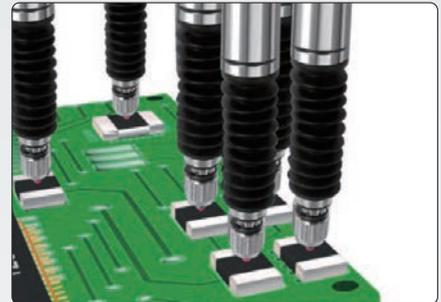
電子部品の寸法計測
