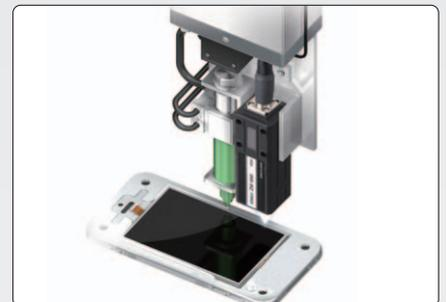
ディスペンサーノズルの高さ制御
